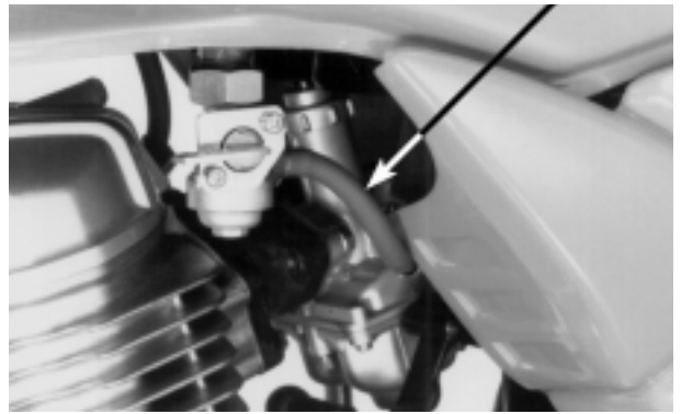
LINEA DE COMBUSTIBLE
