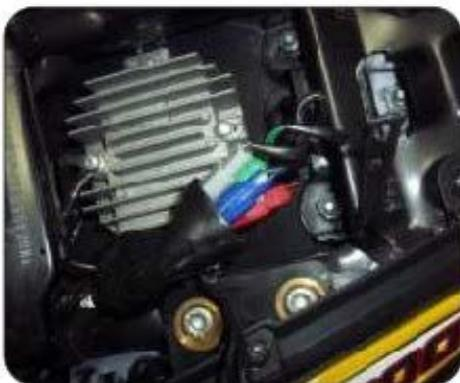
Desconecte las conexiones del acoplador de luz piloto usando la llave de tubo de 12mm
