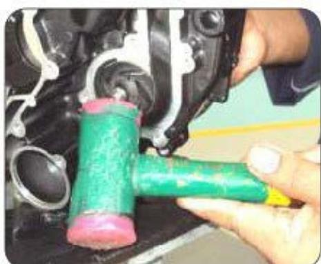
Golpee ligeramente el eje del balanceador para retirar el rotor
