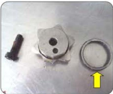
Asegure la instalación del espaciador cuando ensamble el engranaje guía.
