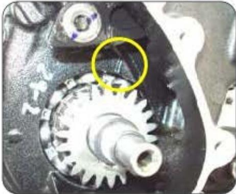
*Al alinear las marcas para el conductor balanceador y el engranaje del controlador, siempre asegúrese que ...*
