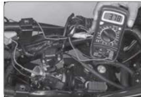
Verificación de voltaje de salida
