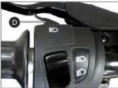
D. Interruptor de paso: Presione el interruptor para colocar el filamento de Luz Alta del faro delantero. Se utiliza para alertar a los vehículos que vienen en dirección contraria mientras adelanta a un vehículo.
