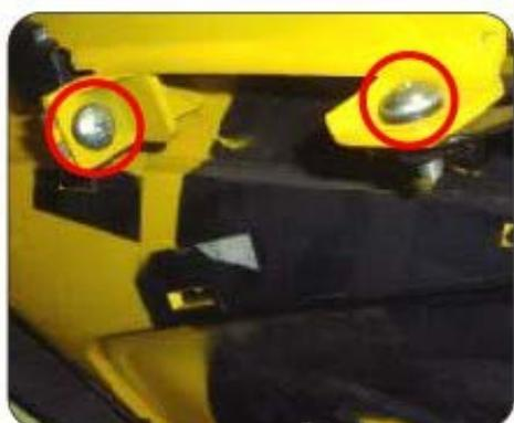
Uso de destornillador Phillips y llave para tuerca de 8mm
